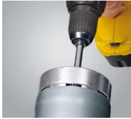
Zuverlässiges Aufweiten mit dem MASC-Aufweitzer
