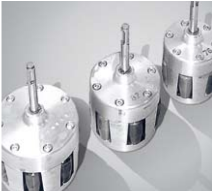
Der MASC-Aufweitzer ist in allen RHEINZINK-Fallrohrgrößen lieferbar.
